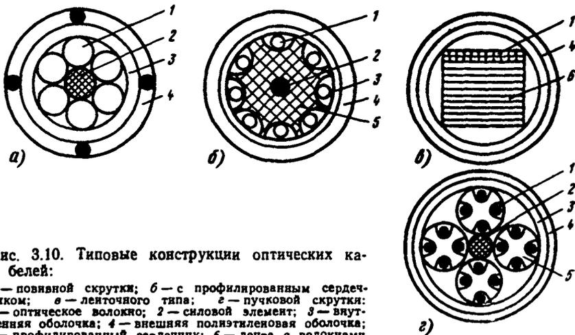
Рис. 3.10. Типовые конструкции оптических кабелей:
